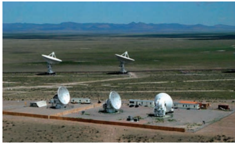
図1. NRAO VLAサイトのALMA 12-mプロトタイプアンテナ3台(前列). 前列左が実験に用いられたNAOJアンテナ. 後列に見えるのはVLAの25-m素子アンテナ.
