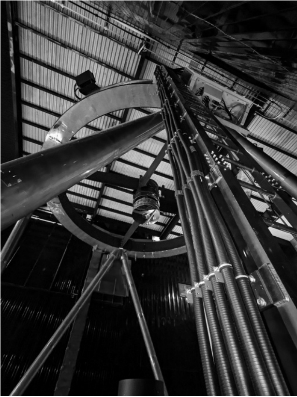
図2. 望遠鏡に搭載された、4組の光ファイバーバンドル（2023年5月）。約2400本の科学観測用ファイバーがこの中を通っている。
