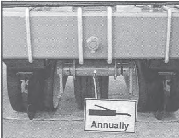
4. Wheel Module Shaft - 1 Zerk Per Module
