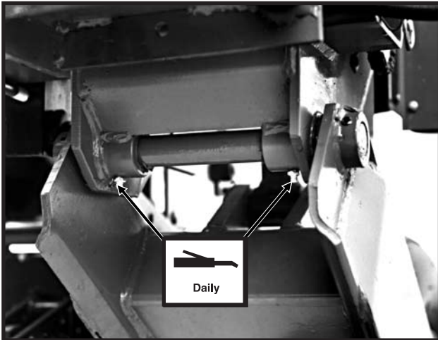
2. Wing Wheel Pivot - 2 Zerks Per Wheel Module
