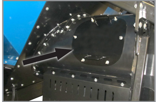
Horizontal Auger Cleanout door
