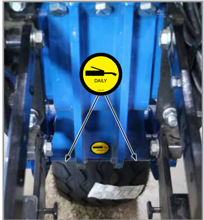
6. Wheel modules, 4 per machine 2 fittings per module
