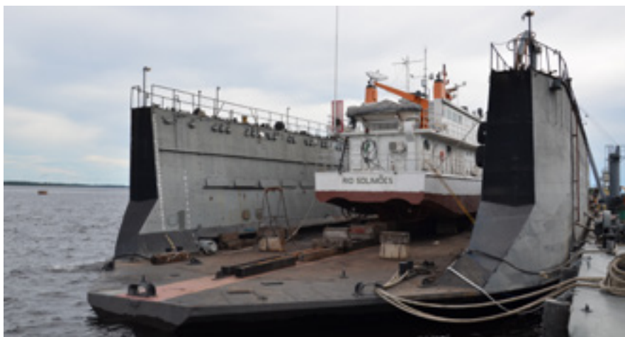
Docagem do AvHoFluRioNegro e do AvHoFluRSolimões no Dique Flutuante Jerônimo Gonçalves (Fonte: MARINHA DO BRASIL)
