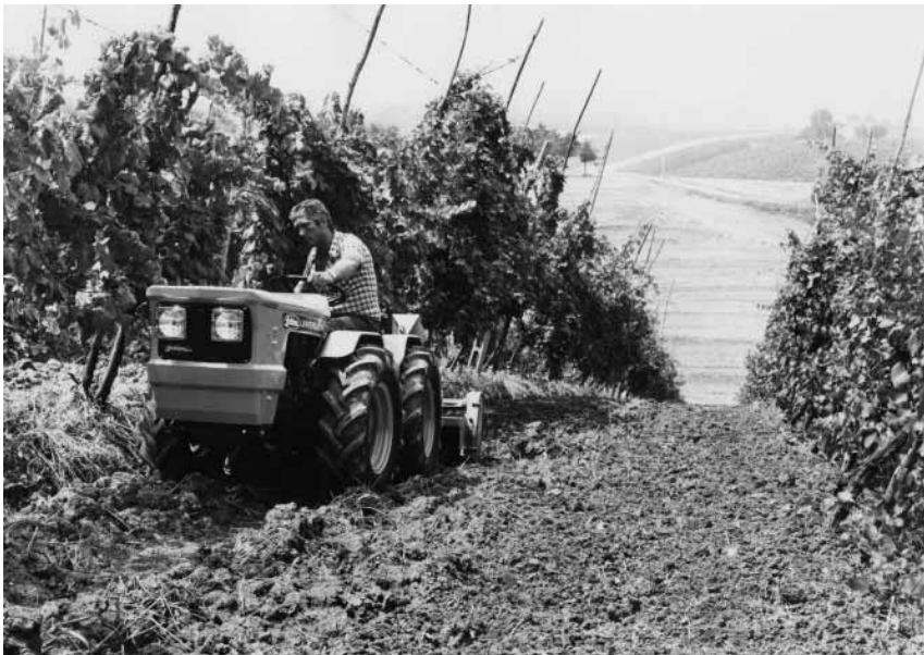
Viticultura meccanizzata. Trattore Goldoni 4 RM con zappatrice in interfilari di vigneti collinari
