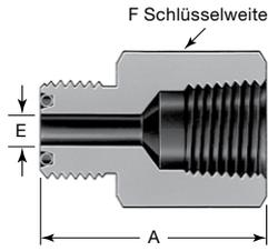
**Aufschraubkörper mit NPT-Innengewinde**
