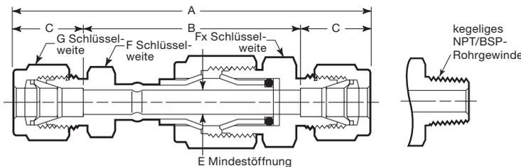
**Vorsicht: Die Isolierungsverbindung nicht demontieren. Sie darf nicht abgetrennt oder als Trennstelle verwendet werden.**
