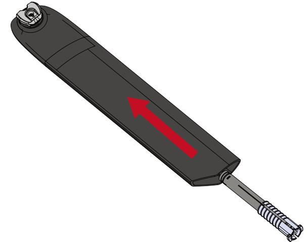
**1-6** 組み付ける前に、図のようにウェッジを調整する必要があります。M4ボルトはウェッジ部品をまとめるだけで、シートポストの締め付けには関与しないことに注意してください。
