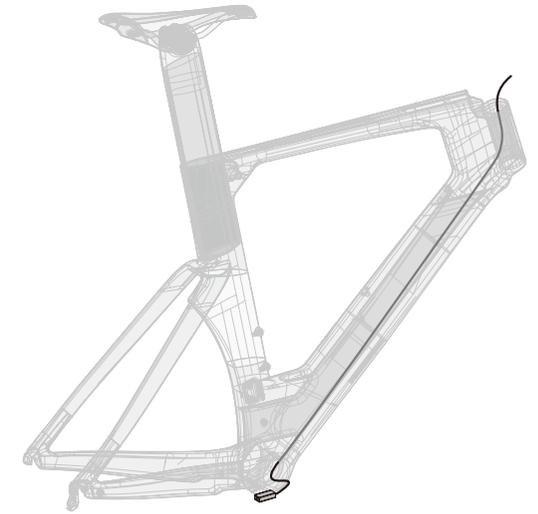
Di2ケーブルをジャンクションAからジャンクションBへ(写真のように)ダウンチューブを通してボトムブラケットシェル<sup>①</sup>の出口窓まで配線します。
