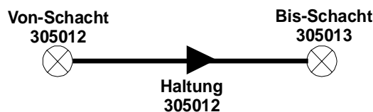
Abb. A-1 - 2 Beispiel Schacht-/Haltungsbezeichnung
