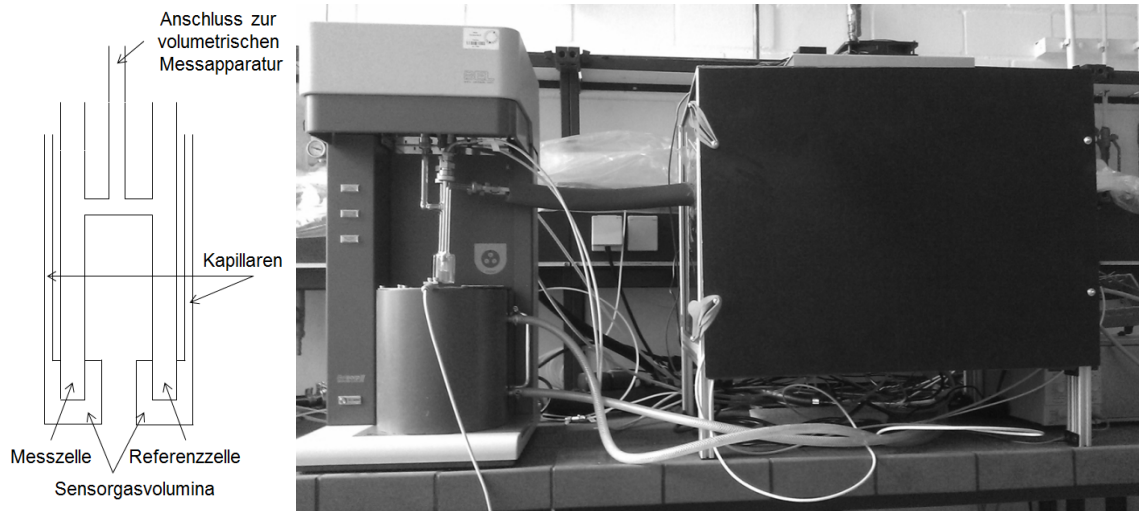
Abbildung 18: Probengefäß in Zwillingsanordnung mit externer Kalorimeterzelle (links) und der Versuchsaufbau mit Probengefäß in Zwillingsanordnung mit externer Kalorimeterzelle (rechts)
