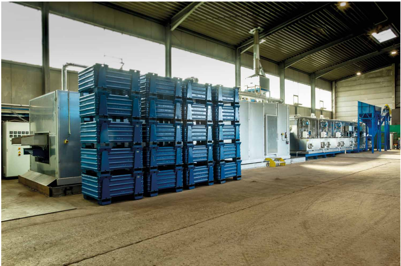
Bild 4: Komplettaufbau der Entölungsanlage mit der Aufgabeeinheit am rechten und dem Späneaustrag am linken Bildrand.
