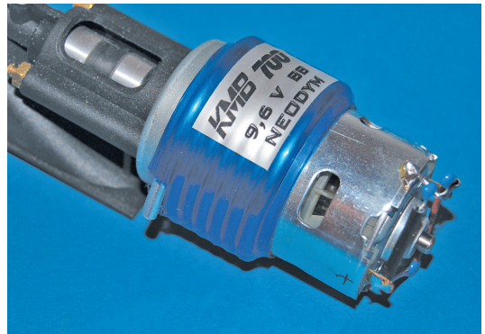
Johnson 700, 9,6-Volt-Neodym-Motor mit aufgedrehter Kühlschlange.
