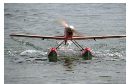
Sebart Macchi mit V-Kiel: Der V-förmige Kiel verbessert das Startverhalten, erzeugt aber auch Spritzwasser, was bei manchen Modellen störend sein kann, speziell wenn das Spritzwasser den oder die Propeller trifft
