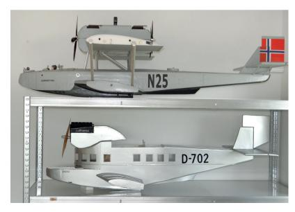
Vergleich N25 (5°) zu D702 (12°): Die N25 setzt leichter mit dem Heck auf und muss in Gleitfahrt stärker mit dem Höhenruder unter Kontrolle gehalten werden. Die D702 hat mehr "Bodenfreiheit" am Heck beim Gleiten
