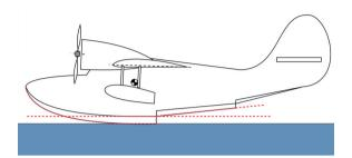
Der vordere Rumpf verläuft in einer harmonischen runden Kurve. Hinter der Stufe verläuft der Rumpf mit zirka 5° bis 12° nach oben
