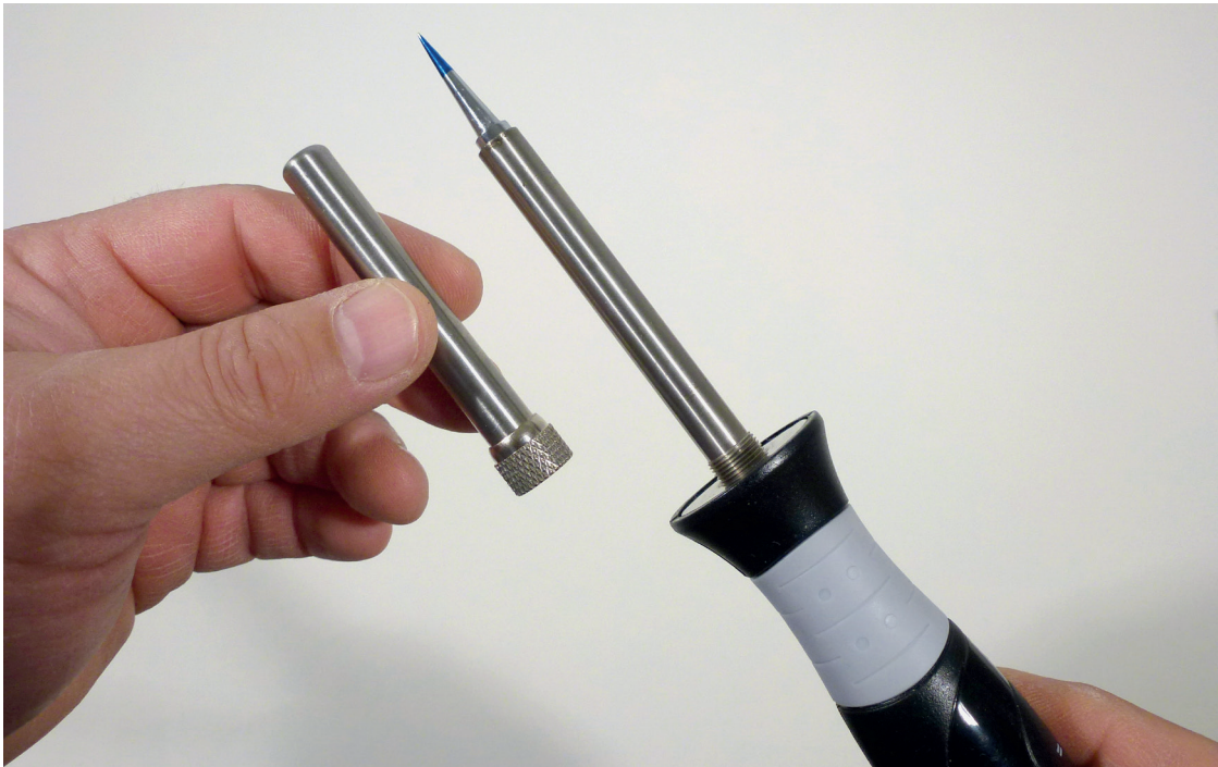
Anschließend ist die Hülse von der Spitze zu ziehen
