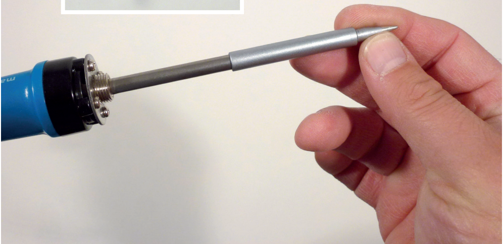
Bei diesem LötKolben steckt die Spitze auf dem Heizelement
