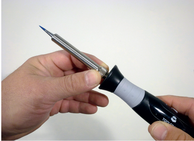
Die Rändelschraube wird gelöst
