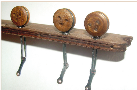
Rüstjungfer und Püttingseisen fertig zum Einbau
