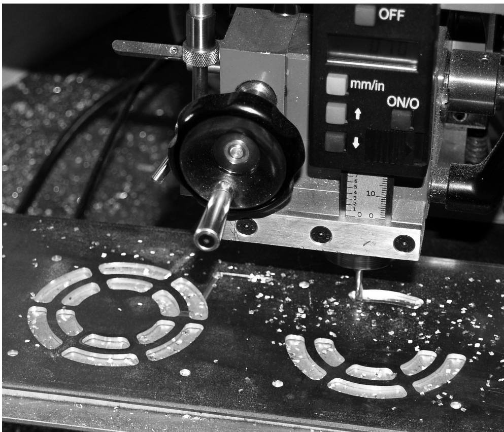
Abb. 6: Fräsen der Lufteintritte in der Rückwand des Steuerungs-Gehäuses
