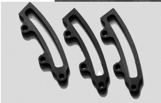
Abb. 5: Kulissen der Stephenson-Steuerung
