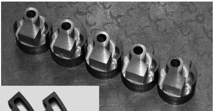
Abb. 4: Die Halter der Umsteuerwelle, noch mit dem Rohmaterial verbunden
