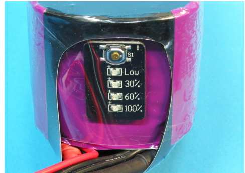
In den LiPo integrierte Spannungsmesser informieren auf Knopfdruck über den Ladezustand
