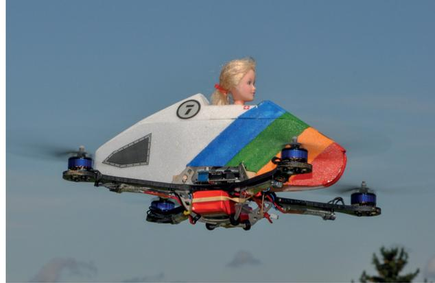
**Bild 191: Quer-Schwebelage eines Quadrocopters vom Piloten aus gesehen**
