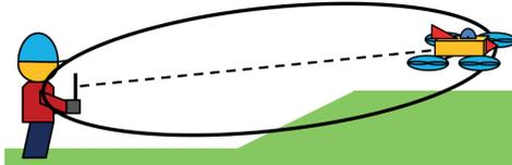
**Bild 67: Fresnel Zone bei unebenem Boden**
