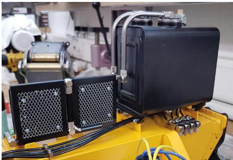
**Abbildung 40: Öltank Effer 1750 mit Öl-Kühler**
