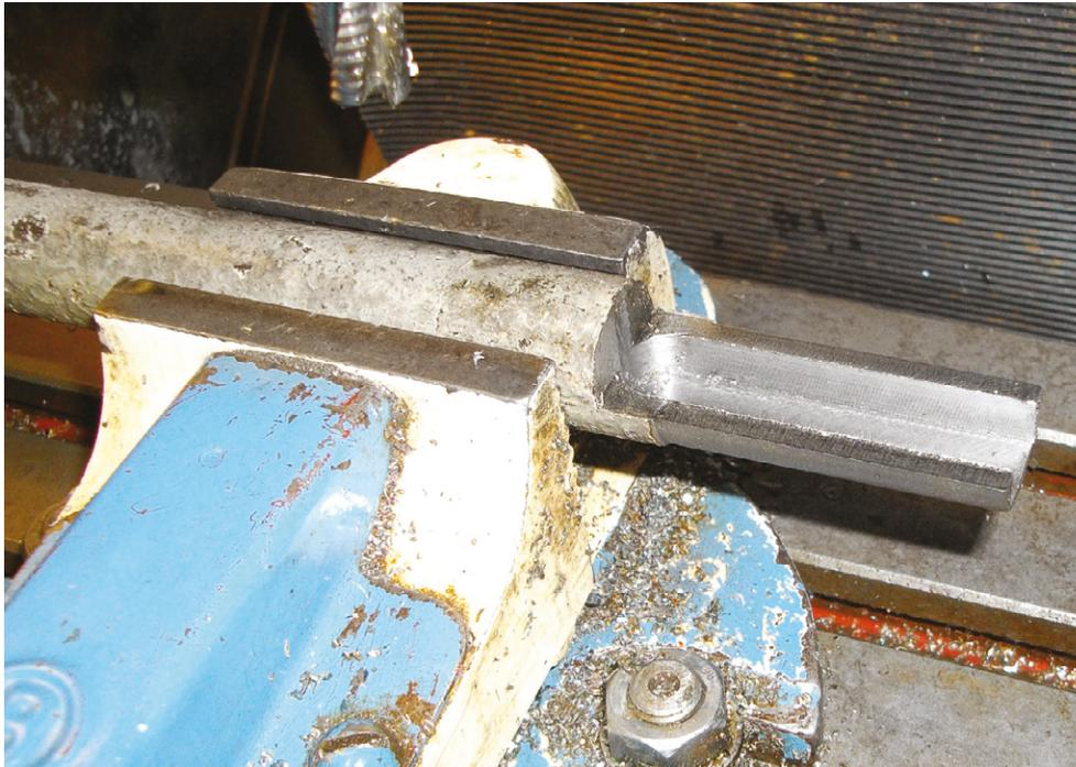
Die Hälfte ist abgefräst und die Nut fertig
