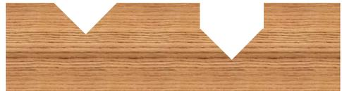
Formen, die mit einem V-Nutfräser gefräst werden können
