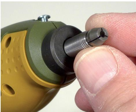
Die Welle ist bereits mit einer für den Spannzangen-Einsatz optimierten Bohrung versehen. Womit sich die Spannzange leicht einsetzen lässt
