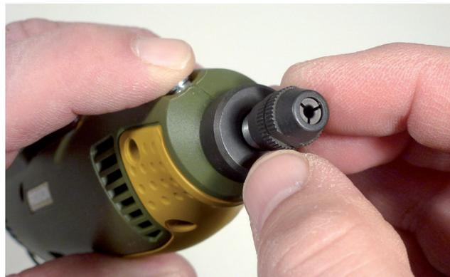
Es braucht nur noch die Überwurfmutter angeschraubt zu werden und schon ist das neue Spannsystem am FBS 240/E einsatzbereit
