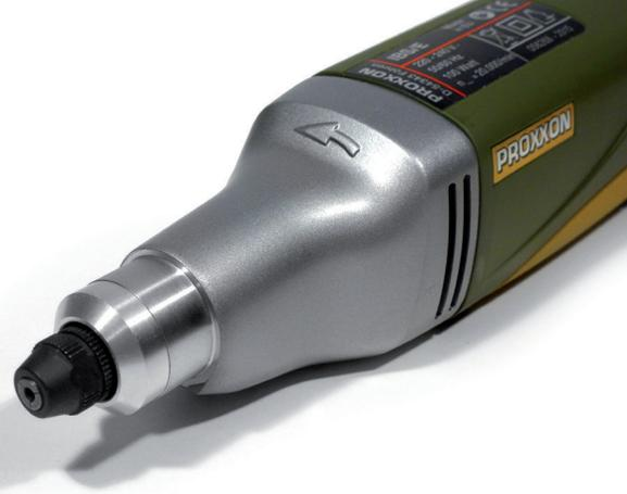
Die Spannanzgen-Überwurfmutter ragt beim Industrie-Feinbohrschleifer IBS/E mehrere Millimeter in den Bohrkopf hinein
