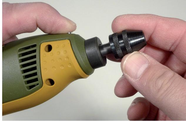
Das Schnellspannbohrfutter lässt sich leicht von der Welle des FBS/E abschrauben
