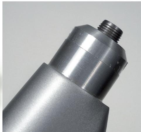
Ist die Überwurfmutter abgeschraubt, ragt die Welle nur wenige Millimeter aus dem Bohrkopf heraus. Zu wenig, um ein Bohrfutter aufzuschrauben
