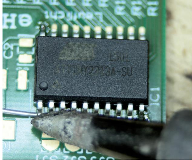
Beim Lötvorgang ist es wichtig, sowohl das Bauteil als auch das Lötpad gleichzeitig auf Temperatur zu bringen. Anschließend wird etwas Lötzinn an die Lötstelle gegeben. Um etwas rationeller vorzugehen, verzinne ich eine ganze Reihe von Pads um dann die Bauteile „In Serie“ zu bestücken
