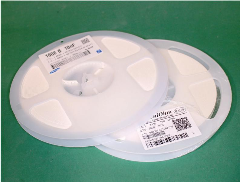
Die Bauteile liegen fein säuberlich aufgereiht in kleinen Wannen, sodass Sie vom Bestückungsautomaten gegriffen werden können
