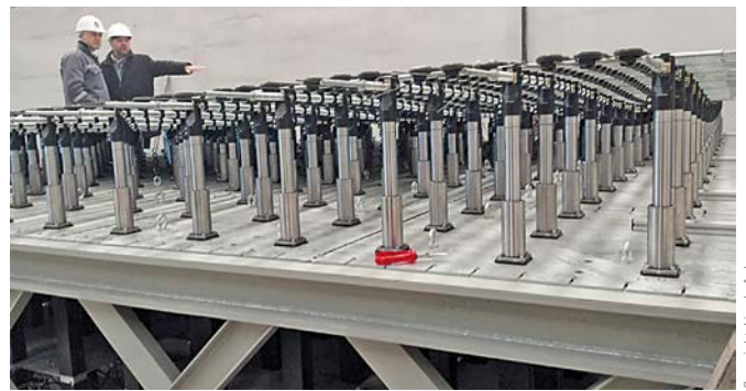
Bild 10 Adaptive Schalungstische der Firma Adapa, Aalborg Adaptive formwork tables made by Adapa, Aalborg
